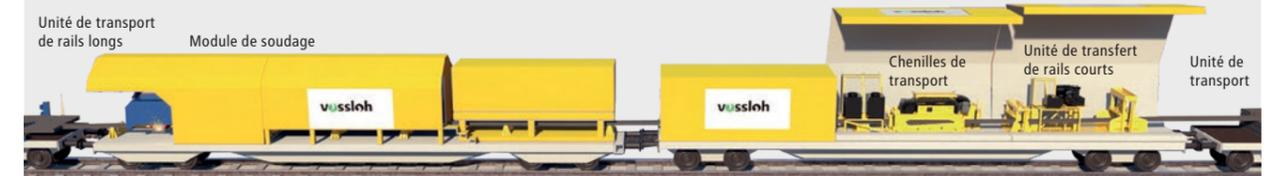
Les rails courts soudés aux rails longs sont déplacés sur l'unité de transport, où le polissage final a lieu après refroidissement.
