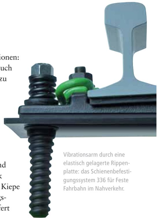
Vibrationsarm durch eine elastisch gelagerte Rippenplatte: das Schienenbefestigungssystem 336 für Feste Fahrbahn im Nahverkehr.
