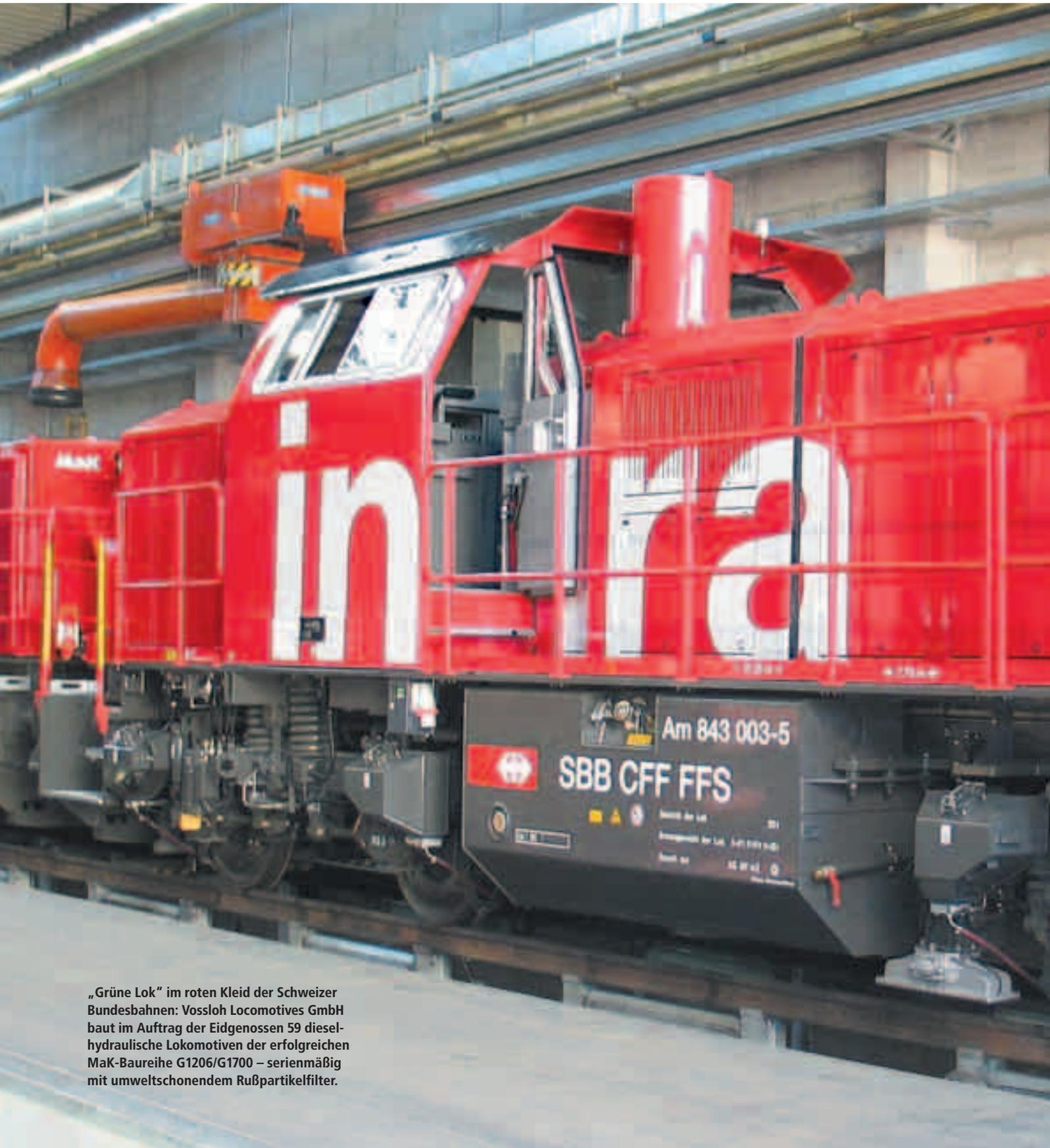
„Grüne Lok“ im roten Kleid der Schweizer Bundesbahnen: Vossloh Locomotives GmbH baut im Auftrag der Eidgenossen 59 dieselhydraulische Lokomotiven der erfolgreichen MaK-Baureihe G1206/G1700 – serienmäßig mit umweltschonendem Rußpartikelfilter.
