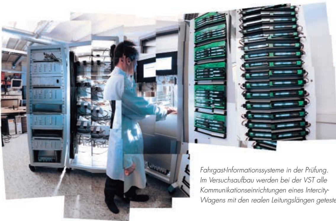
*Fahrgast-Informationssysteme in der Prüfung. Im Versuchsaufbau werden bei der VST alle Kommunikationseinrichtungen eines Intercity-Wagens mit den realen Leitungslängen getestet.*
