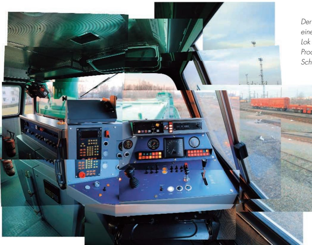
*Der moderne Führerstand einer dieselhydraulischen Lok aus der Kieler Produktion der Vossloh Schienenfahrzeugtechnik.*
