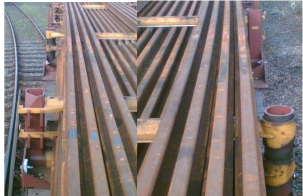
ohne Steckbolzen: Schienen gleiten quer frei
