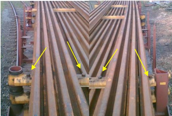
Steckbolzen über Drehgestell: Schienen quer fixiert
