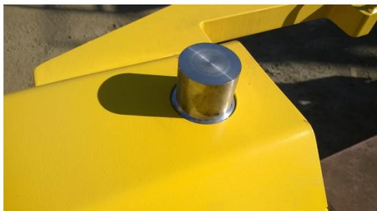
Steckbolzen in Drehschwelle
