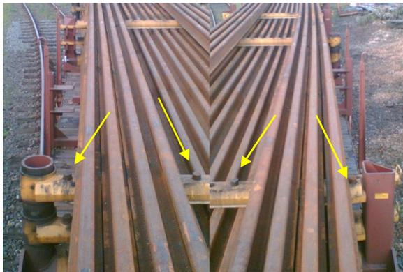
Steckbolzen über Drehgestell: Schienen quer fixiert
