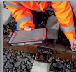
Ultraschallprüfung mit SQ 3000 ohne RRR-Trolley möglich
