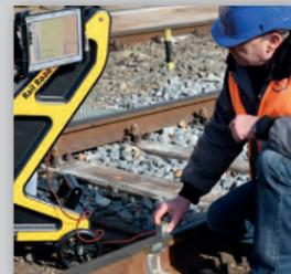
RRR-Trolley verbunden mit separatem Standard-Ultraschallprüfkopf
