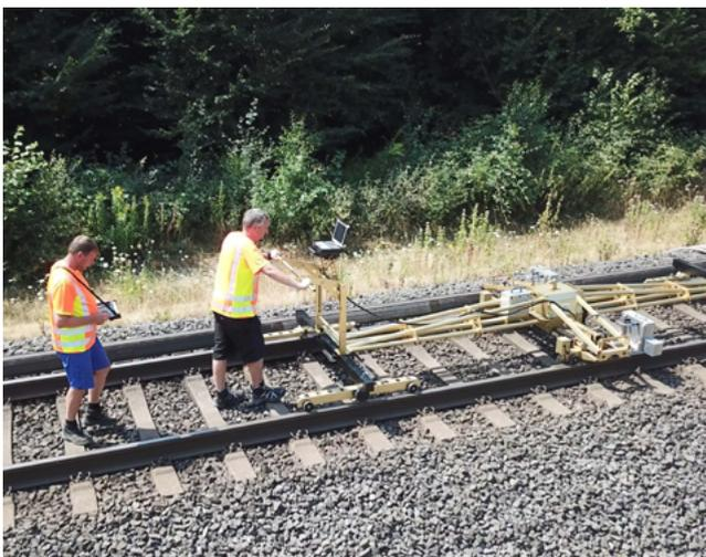
Messung der Gleisgeometrie mit EMA uni
