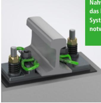
Die Spannklemme Skl 24 punktet durch einen hohen Durchschubwiderstand: Zwei hochelastische und unabhängig voneinander arbeitende Federarme halten die Schiene dauerhaft nieder. Für zusätzlichen Kipp-schutz sorgt die Mittelschleife. Ein weiterer Vorteil ist die Wartungsfreiheit des Systems: Durch die dauerhafte Verspannung können sich Spannklemme und Schraube nicht lösen.
