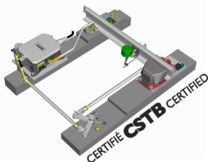
A chaque manœuvre, le fonctionnement des éléments de tringlerie sans graissage, les réponses du moteur MCEM91 (efforts moteur), du verrouillage et du contrôle de position (VCC+contrôleur) étaient vérifiés. **Aucun défaut n'a été constaté sur les contacts électriques. Le bon fonctionnement du système complet a été constaté tout au long de l'essai.**
