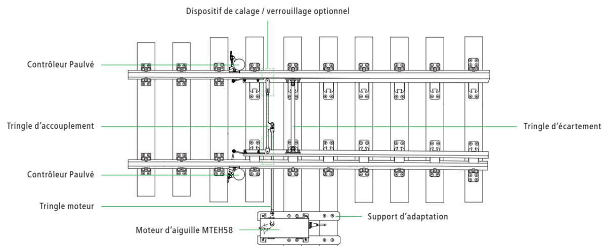
Installé en bord de voie, le moteur d'aiguille MTEH58 manœuvre l'aiguillage au moyen d'une tringle unique, attelée directement aux aiguilles ou connectée à un dispositif de calage tiers.
